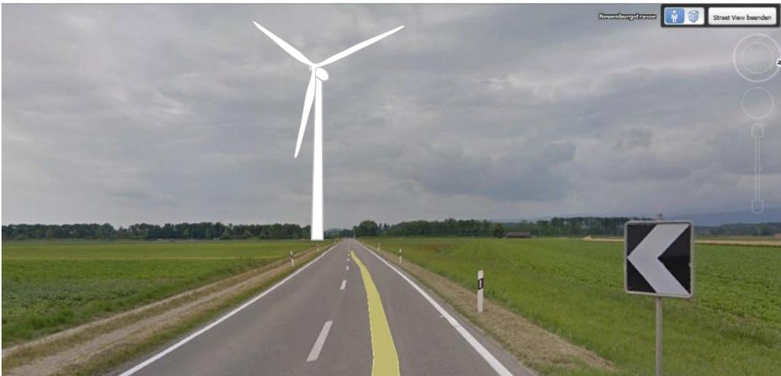
Die Landeskoordinaten der zu untersuchenden Standorte wurden nach Google Earth exportiert. Für die WEA wurde die Höhe von 250 m definiert und mit einer Linie an die Bodenoberfläche verbunden. Mit diesem Street View Foto von exakt dem gleichen Standort konnten der Standort und die Höhen der WEA ausreichend genau montiert werden. Diese Visualisierung ersetzt keine professionelle Fotomontage. Sie dient der internen Meinungs- und Entscheidungsfindung.
